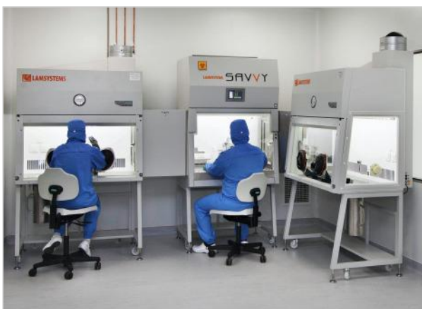
С помощью передаточных шлюзов оборудование может компоноваться в единую производственно-технологическую линию
